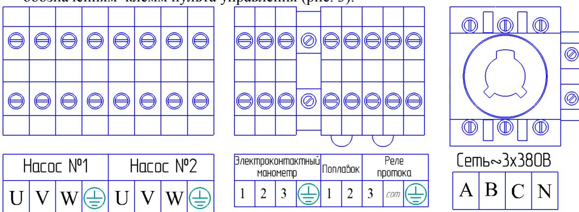
На клеммной колодке пульта управления вместо реле протока и поплавкового выключателя установлены перемычки.
